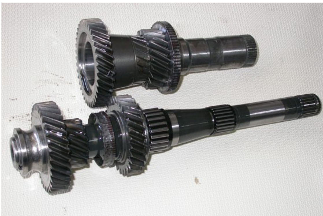
Первичные валы. Сверху - четных передач, снизу - нечетных и заднего хода. Вал четных передач полый, сквозь него проходит вал нечетных передач, когда DSG собрана. Эта хитрость позволила разместить в одном корпусе две 3-ступенчатые МКП
